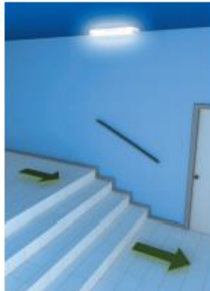
I nærheten av trapper slik at alle trinn er direkte belyst.
